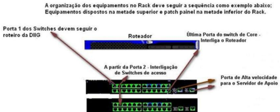
Figura 4: Exemplo de organização de equipamentos no rack
